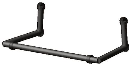
Figura 52: Modelo da barra estabilizadora da suspensão dianteira do chassi.
