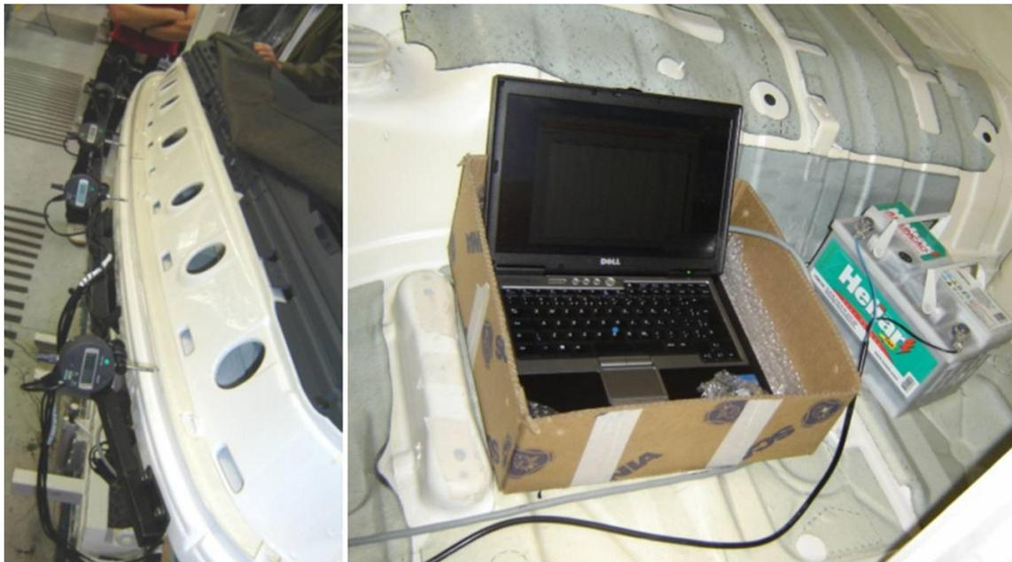
Figura 89: Levantamento dos deslocamentos e velocidades do parabrisa durante cura do adesivo no processo de montagem.
