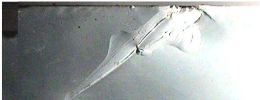
Figura 87: Análise em microscópio eletrônico da trinca devido a impacto de baixa energia ou colisão por pedras. [Fonte: Pilkington, 2009]
