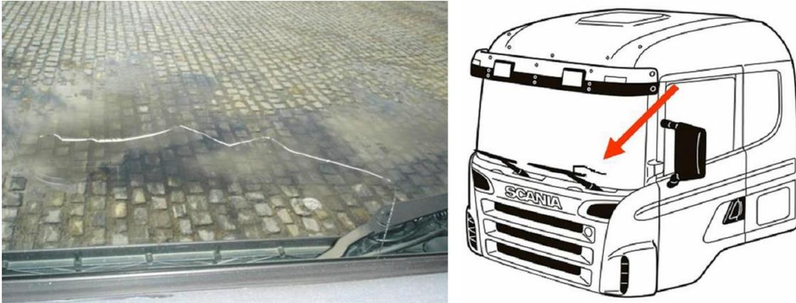
Figura 6: Trinca de parabrisa na região inferior.
