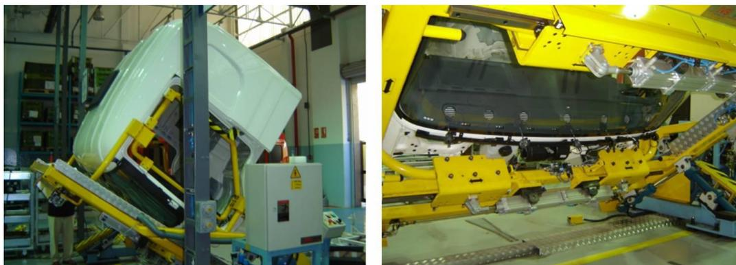
Figura 91: Basculamento da cabina logo após a cura estimada do adesivo.
