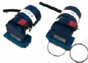
Figura 65: Transdutor analógico de deslocamentos. [Fonte: Tenneco Monroe, 2009]
