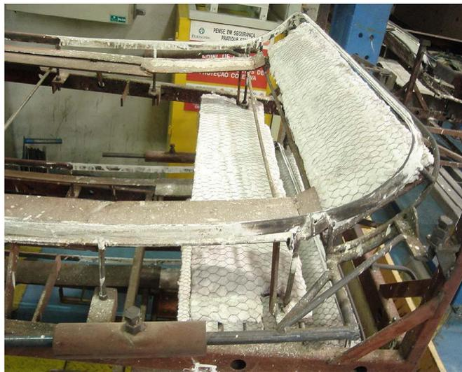
Figura 85: Ferramenta do processo de fabricação do parabrisa. [Fonte: Pilkington, 2009]
