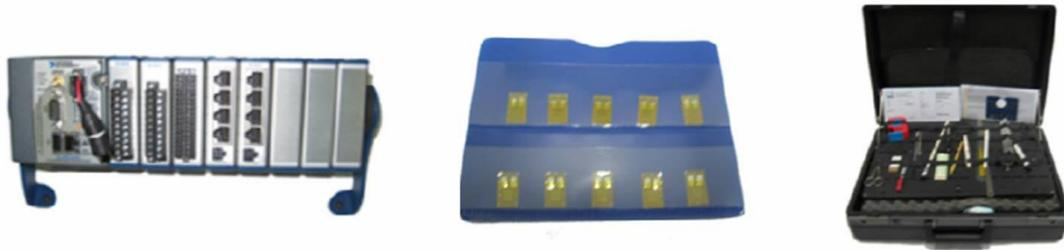
Figura 64: Receptor CompactRio 9012 Real Time, strain gauges HBM e caixa de ferramentas para instalação. [Fonte: Tenneco Monroe, 2009]
