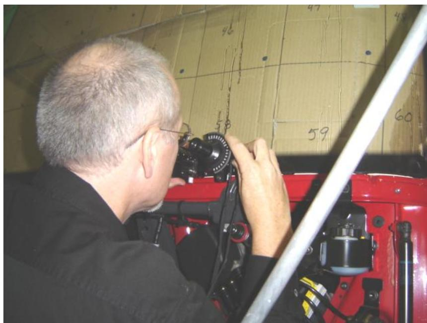
Figura 88: A medição das tensões diretamente no caminhão.
