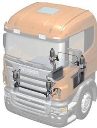
Figura 3: Cabina com suspensão 4-pontos.
