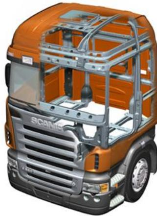
Figura 2: Estrutura de uma cabina.
