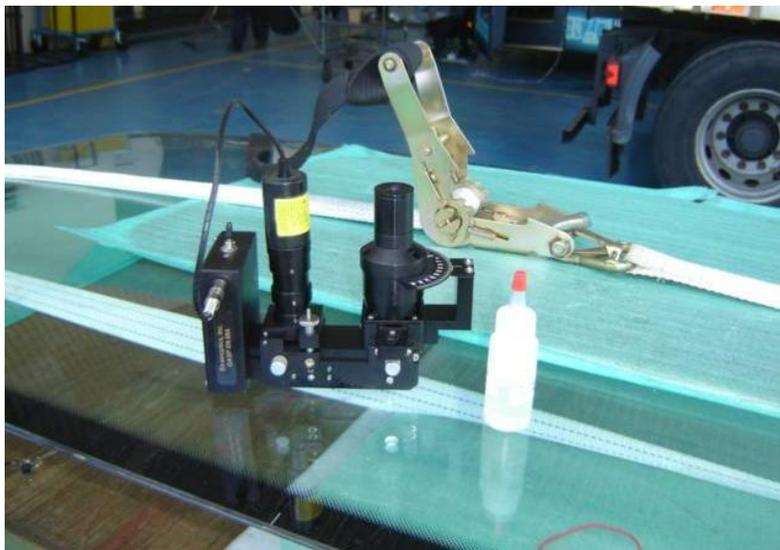
Figura 92: Ensaio destrutivo para determinar as máximas tensões e deslocamentos do parabrisa utilizando o equipamento óptico.
