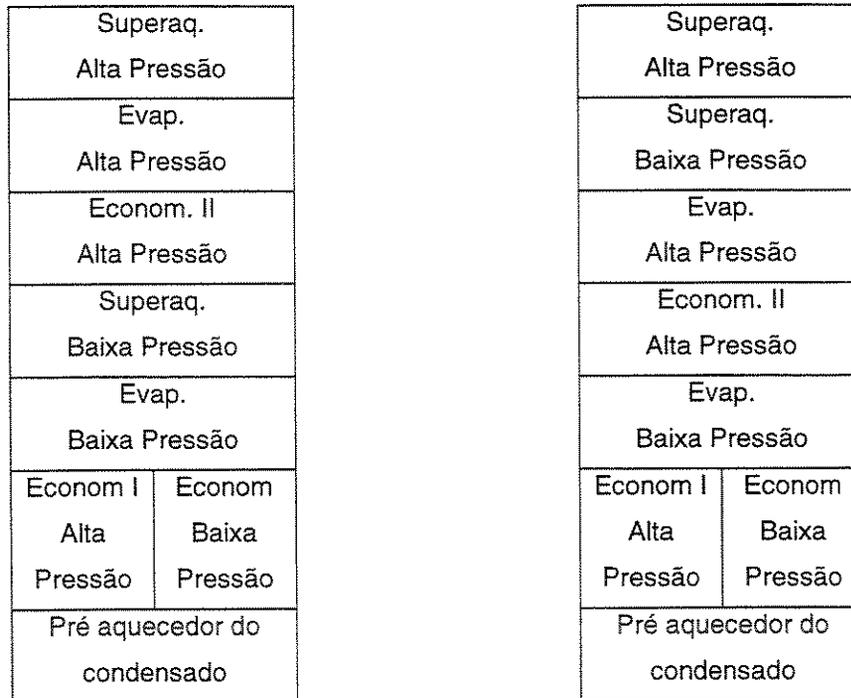
**Figura 6.13: Esquema de HRSG para as configurações CC3 e CC5.**
