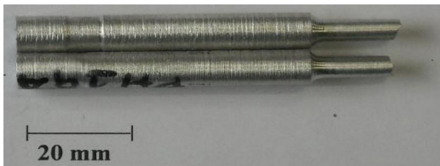
Figura 3.17: Corpo de prova após o ensaio de tração
