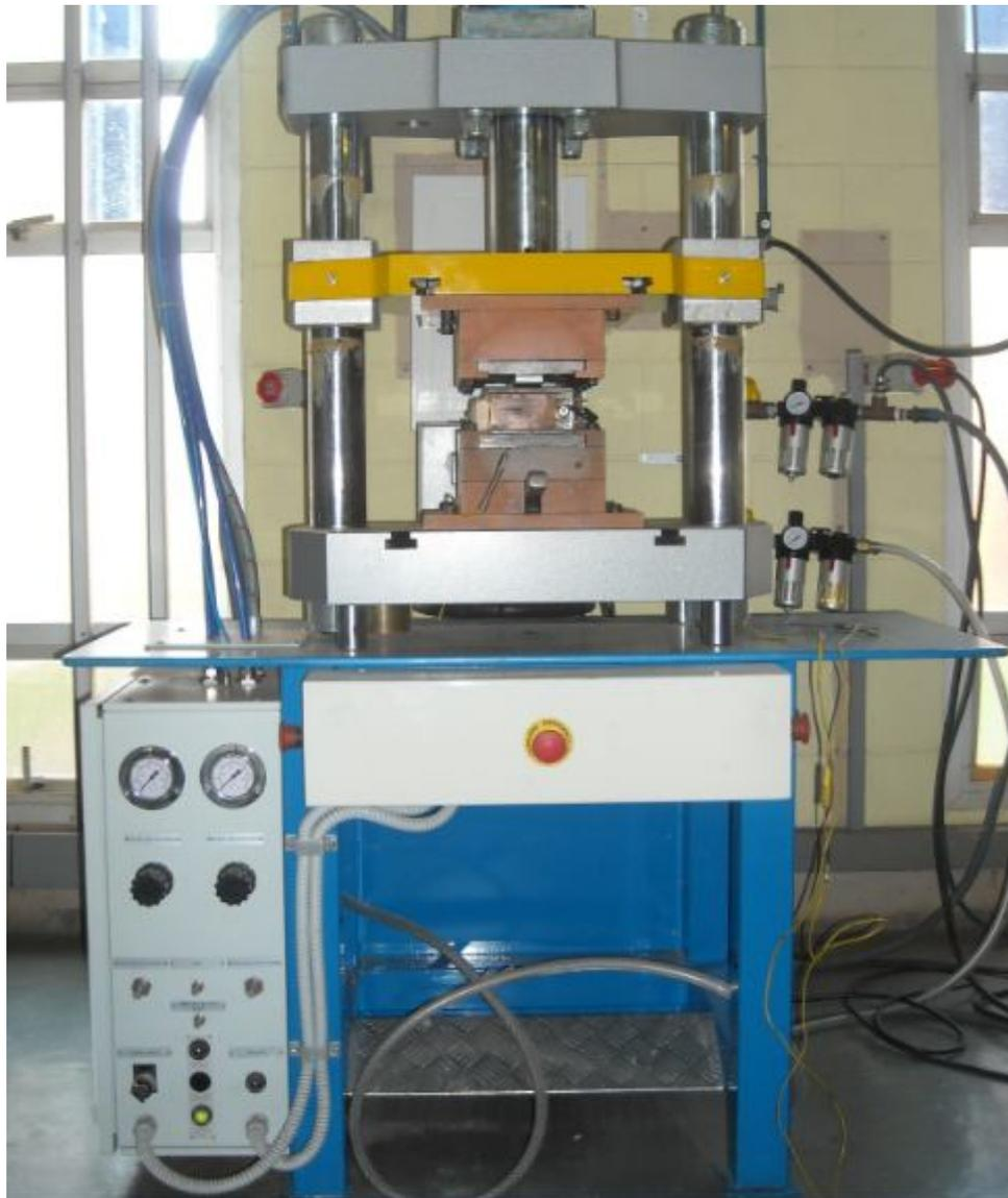
Figura 3.10: Prensa Hidráulico Pneumática utilizada.
