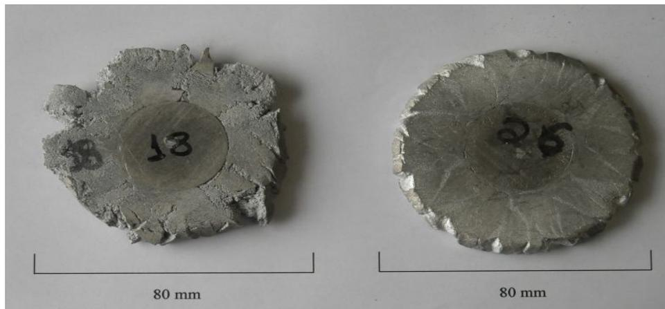
Figura 3.5: Liga Tixoformada de Al-4%-Si-5%Zn com 55% e 45% de fração sólida respectivamente;
