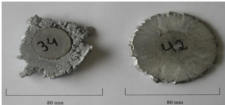
Figura 3.6: Liga Tixoformada de Al-5%-Si-5%Zn com 55% e 45% de fração sólida respectivamente;
