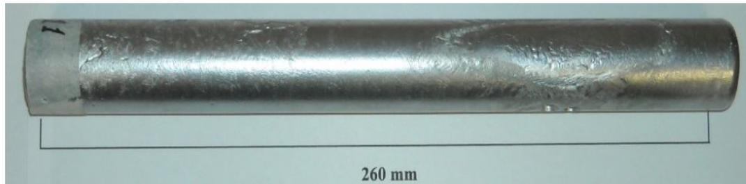
Figura 3.3: Lingote logo após sair do motor de indução eletromagnética
