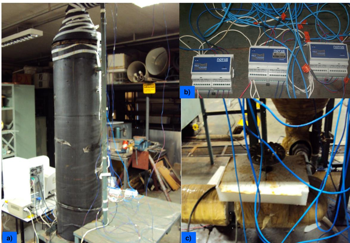
FIGURA 3.2 - Processo de solidificação e fusão do gelo: a) armazenador cilíndrico; b) termopares conectados no DATA LOGGER; c) válvula agulha para controle da entrada do fluido.
