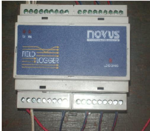
FIGURA 3.7 - Detalhe do sistema do FIELD LOGGER para aquisição de dados.
