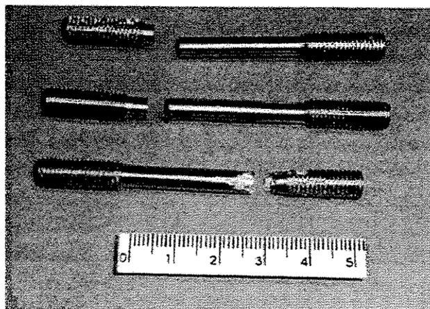
**Figura 5.29** Corpos-de-prova após ensaio de tração.
