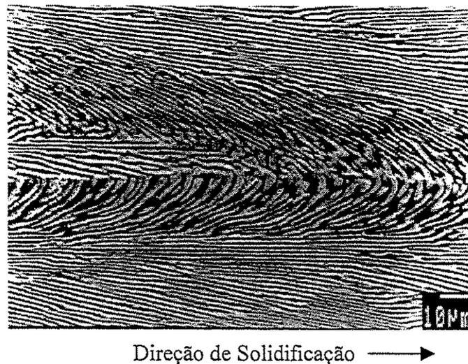
Figura 5.1 Microestrutura do eutético Ni-Ni<sub>3</sub>Si no estado bruto de fusão.
