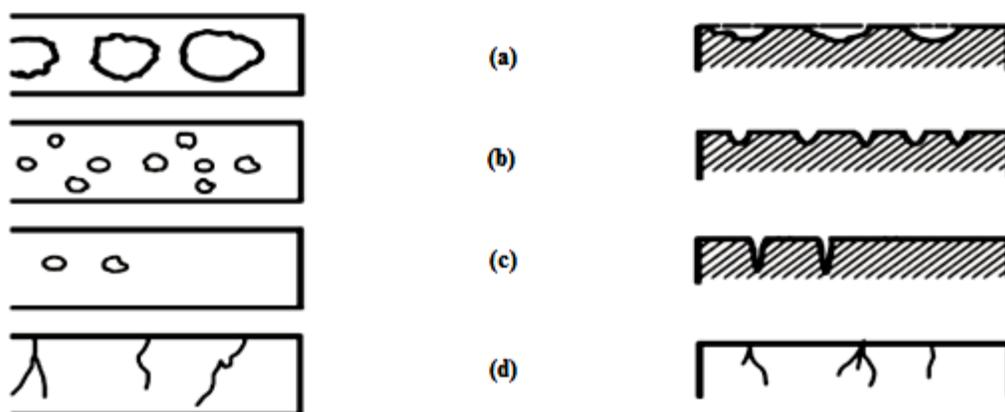
Figura 2.7 Diferentes formas de corrosão por pite: a) Pites largos, b) pites médios, c) pites profundos e d) pites com presença de microtrincas (SHREIR, 1978).
