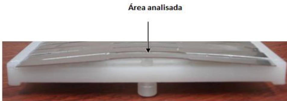
Figura 3.10 Região investigada no exame microestrutural das amostras tensionadas.
