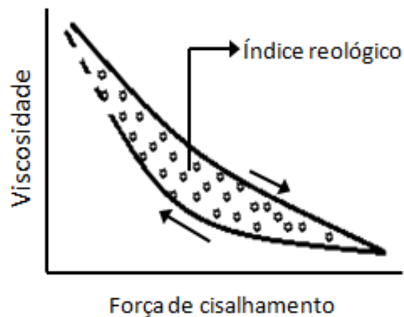
Figura 2.9– Dependência do tempo no comportamento de fluidos não-Newtonianos (Adaptado de Yamaki, 2010)
