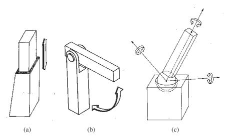
Figura 2.20 - Tipos de juntas utilizadas em manipuladores robóticos. (a) Deslizante. (b) Rotativa. (c) Esférica.
