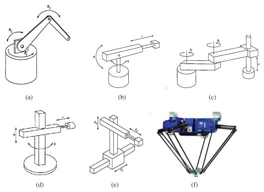
Figura 2.21 - Classes de robôs. (a) Robô de braços articulados. (b) Robô de coordenadas esféricas. (c) Robô SCARA. (d) Robô de coordenadas cilíndricas. (e) Robô de coordenadas cartesianas. (f) Robô de vínculos paralelos.
