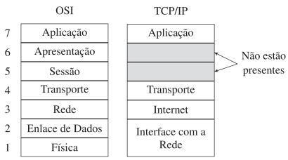
Figura 2.16 - Comparação entre os modelos OSI e TCP/IP. Fonte: Adaptado de (TANENBAUM, 2003)
