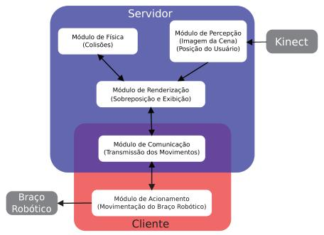
Figura 3.6 - Diagrama de colaboração e fluxo de dados do sistema proposto.
