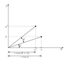
Figura A.5 - Derivação da equação da rotação. Fonte: Adaptado de (FOLEY et al., 1996)
