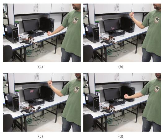
Figura 4.3 - Braço robótico replicando os movimentos do usuário.
