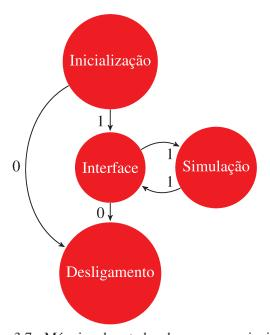
Figura 3.7 - Máquina de estados do processo principal.
