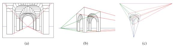
Figura 2.4 - Classes de Projeção em Perspectiva. (a) Um ponto de fuga. (b) Dois pontos de fuga. (c) Três pontos de fuga.
