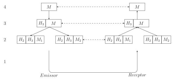
Figura 2.14 - Exemplo de transmissão de dados através de um protocolo de 4 camadas. O protocolo de cada camada do emissor acrescenta um cabeçalho (*header*) que é retirado pelo protocolo da camada superior no destinatário, a fim de reconstruir a mensagem original. O tracejado mostra um circuito virtual. O circuito real é mostrado em linhas sólidas.
