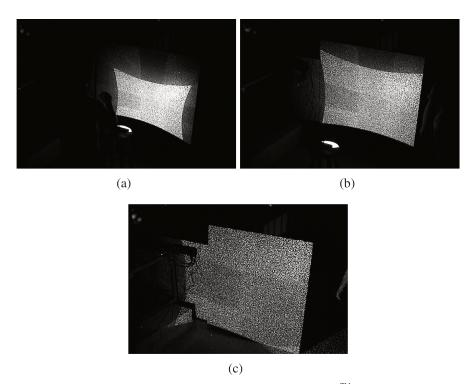
Figura 3.3 - Padrão de pontos aleatórios projetado pelo sensor Kinect<sup>TM</sup>. Os padrões foram fotografados usando uma câmera com filtro IR, com o Kinect<sup>TM</sup> posicionado a distâncias variadas do anteparo.
