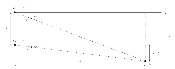
Figura 2.8 - Modelo geométrico de um par de câmeras estéreo. Fonte: Adaptado de (SHAPIRO; STOCKMAN, 2001)
