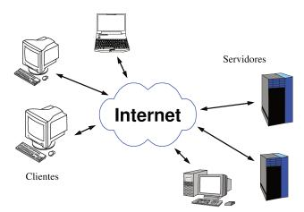
Figura 2.18 - O Modelo Cliente-Servidor.
