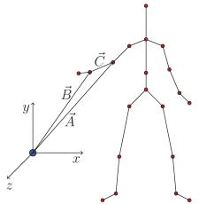
Figura 3.15 - Cálculo do ângulo de abertura da articulação Braço-Antebraço. O vetor  $\vec{C}$  é dado pela diferença de  $\vec{A}-\vec{B}$ .
