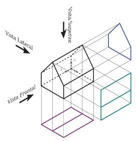
Figura 2.5 - Projeção ortográfica. Cada um dos planos corresponde às vistas frontal, lateral e superior. Fonte: Wikimedia Commons
