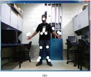
Figura 3.9 - Modelo do esqueleto, mostrando as vinte articulações em sobreposição com a imagem capturada.
