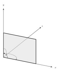
Figura A.7 - Orientação de um sistema de coordenadas 3D levógiro. As setas mostram o sentido positivo de orientação das rotações e translações.
