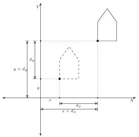
Figura A.1 - Translação de um objeto no plano. O objeto tracejado representa a posição inicial. Note o deslocamento do ponto de referência, na base do objeto.
