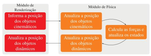
Figura 3.10 - Fluxo de dados do Módulo de Simulação de Física.
