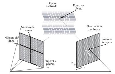
Figura 2.11 - Recuperação de informação 3D a partir de luz estruturada. Fonte: Wikimedia Commons
