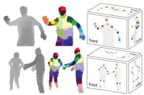
Figura 3.4 - Imagem de profundidade gerado pelo sensor Kinect<sup>™</sup> , seguido da rotulação dos pixels e estimação das posições das juntas.
