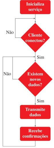
Figura 3.11 - Fluxograma do Servidor.
