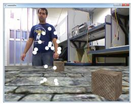
Figura 4.1 - Representação do Usuário no Mundo Virtual. As esferas brancas marcam as posições das articulações detectadas pelo sensor Kinect<sup>™</sup> .
