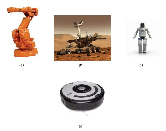
Figura 2.19 - Classes de Robôs. (a) Um manipulador robótico de uso industrial. (b) Sonda Spirit, um exemplo de robô móvel autônomo. (c) Asimo, um robô de serviço humanoide. (d) Um exemplo de robô de serviço não humanoide, o aspirador de pó robótico Roomba.
