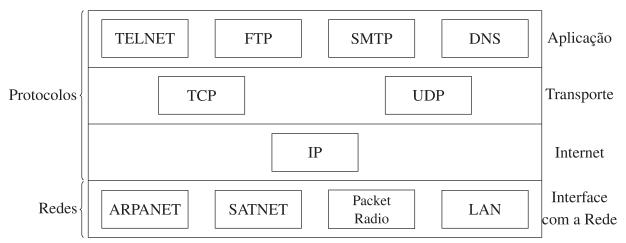
Figura 2.17 - Pilha de protocolos no modelo TCP/IP. Fonte: Adaptado de (TANENBAUM, 2003)
