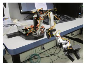
Figura 3.5 - Plataforma Robix<sup>™</sup> Rascal. Sua estrutura modular permite várias configurações.
