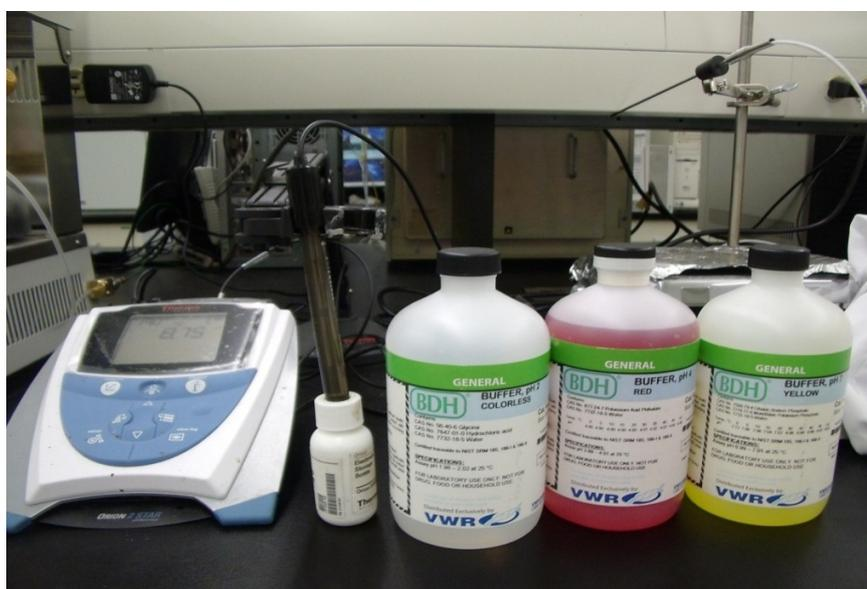
Figura 3.9 - pHmêtro e soluções tampão utilizadas para calibração do equipamento.
