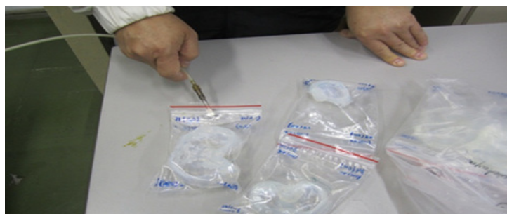
Figura 3.2 - Detalhes da introdução de gás nitrogênio nos invólucros de plásticos contendo amostras de PVA para serem irradiadas
