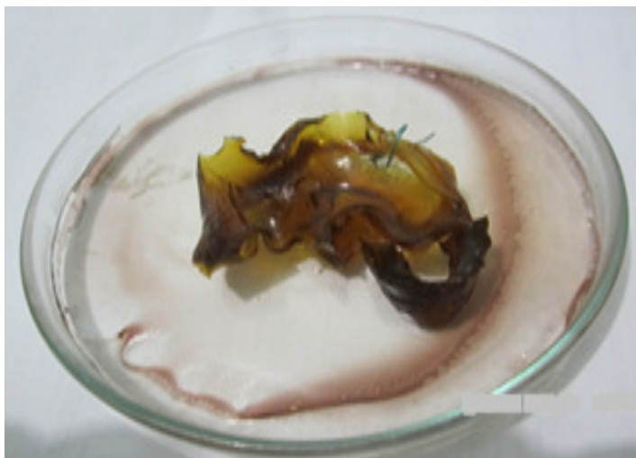
Figura 4.1 - Hidrogel de PVA com resíduo de enxofre resultando em um composto de cor castanha e cheiro característico.
