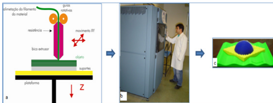
Figura 2.32 – (a) - Imagem do processo FDM ;(b) -.Equipamento correspondente ao processo FDM, (c) - Protótipo obtido. (modificado de Volpato et al, 2007 e Canciglieri jr. et al, 2007).
