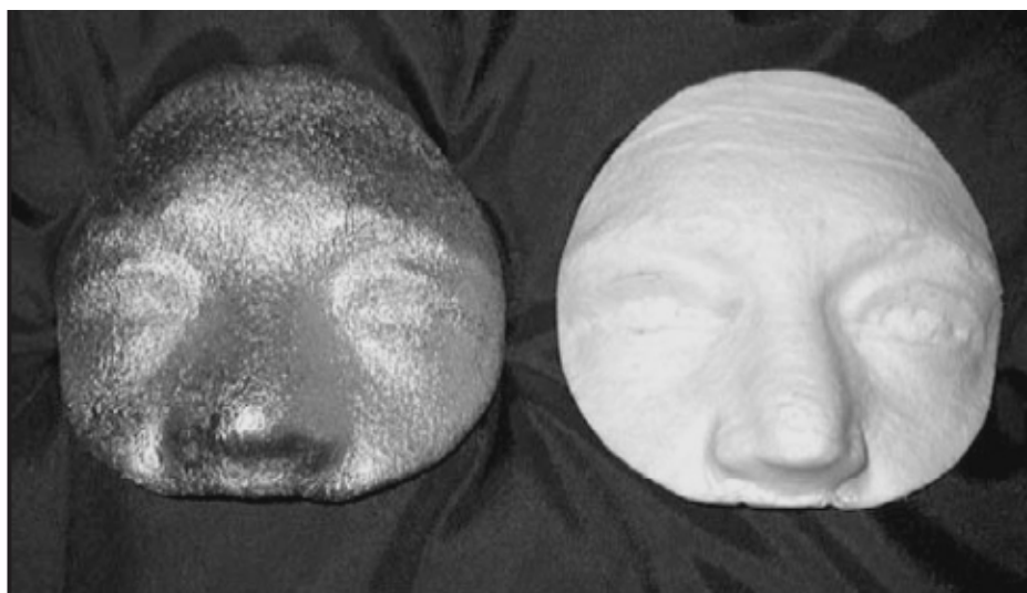
Figura 2.9 – Aplicações em máscaras de tratamento de câncer : Modelo em prototipagem rápida e máscara com spray de metal (Beer, 2005)
