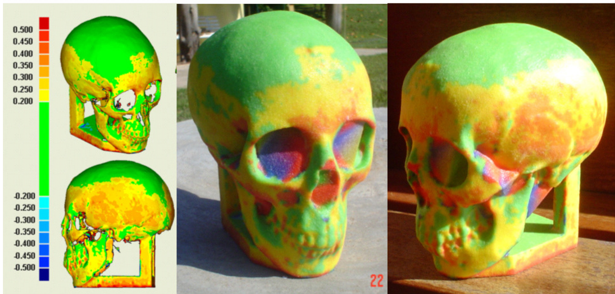
Figura 8.10 – Proposta para procedimento de planejamento cirúrgico: confecção de protótipo em cores com representação das variações dimensionais encontradas no processo
