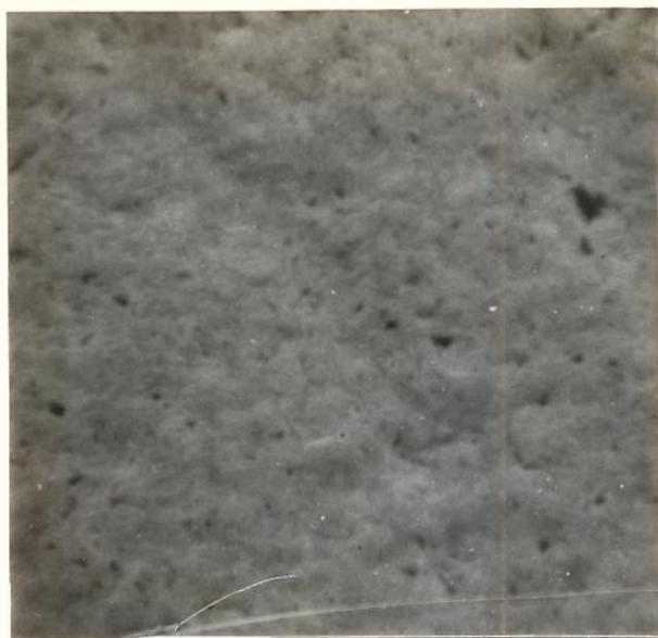
**Foto 9** - Depósito de zinco brilhante, obtido a partir do banho 1 com ajuste de pH e sem a presença de íons de ferro . Aumento de 5.500 X , foi depositado sobre uma chapa de aço.
