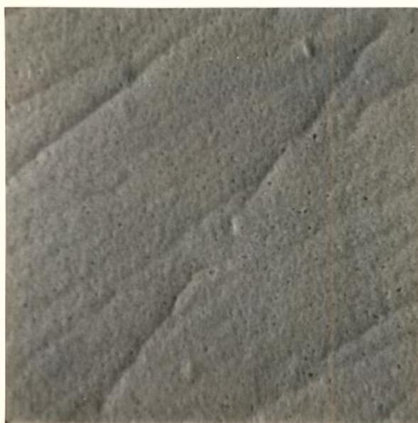
**Foto 08** - Depósito de zinco brilhante, obtido a partir do banho I com ajuste de pH e sem a presença de íons de ferro . Aumento de 1.100 X , foi depositado sobre uma chapa de aço.
