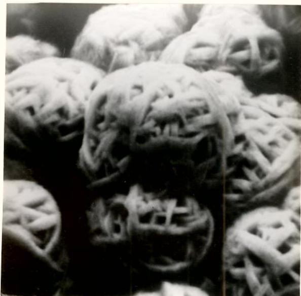
**Foto 07** - Depósito de zinco fosco, obtido a partir do banho I sem ajuste de pH e sem a presença de íons de ferro . Aumento de 5.700 X , foi depositado sobre uma chapa de aço.
