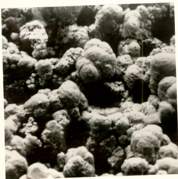
**Foto 06** - Depósito de zinco fosco , obtido a partir do banho 1 sem ajuste de pH e sem a presença de íons de ferro . Aumento de 1.000 X , foi depositado sobre uma chapa de aço.
