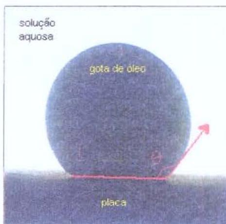
Figura 5.14. Ilustração do ângulo de contato medido sobre a gota de óleo aderida a placa.
