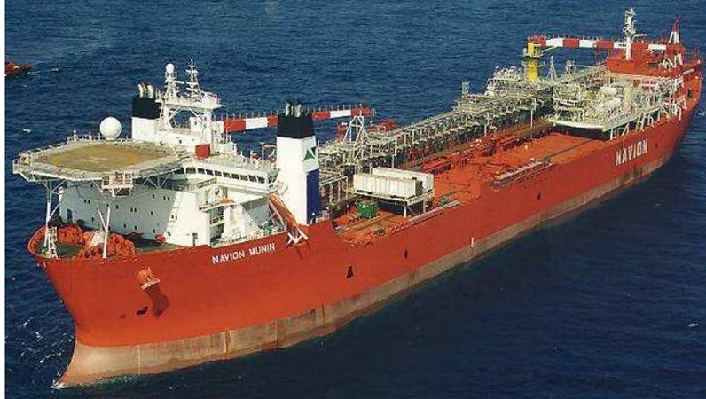
Figura 2.10: Plataforma do tipo FPSO. Unidade de produção do campo Lufeng22-1 localizado na China. (<<http://www.offshore-technology.com/projects/lufeng/lufeng2.html>>)
