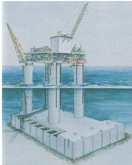
Figura 2.6: Ilustração de uma plataforma por gravidade.
