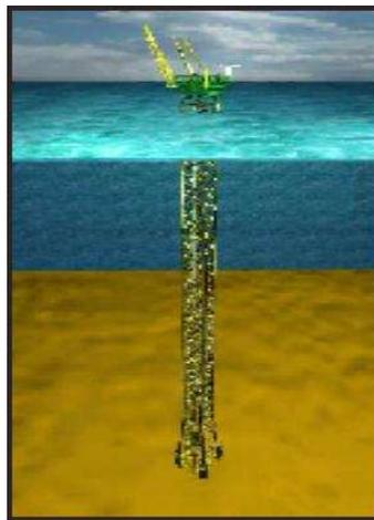
Figura 2.5: Ilustração de uma plataforma torre guia utilizada na produção do campo Baldpate localizado no Golfo do México. (<<http://www.offshore-technology.com/projects/baldpate/index.html>>)
