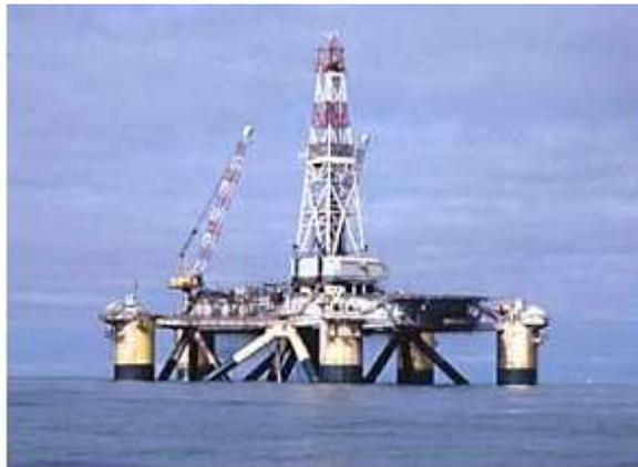
Figura 2.8: Plataforma semi-submersível utilizada para perfuração.
