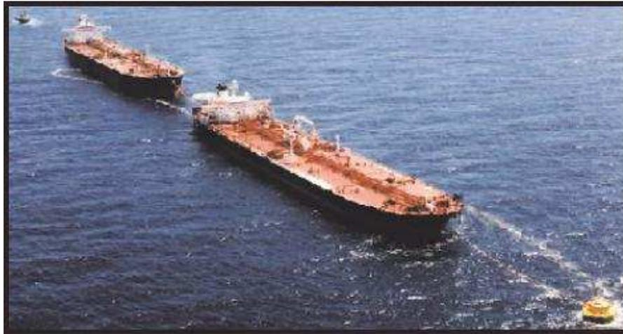
Figura 2.16: Navio tanque ancorado para descarregar o óleo produzido pela plataforma FPSO e transportá-lo até a costa
