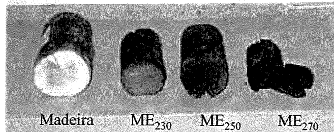
Aspecto da madeira antes e após a torrefação
