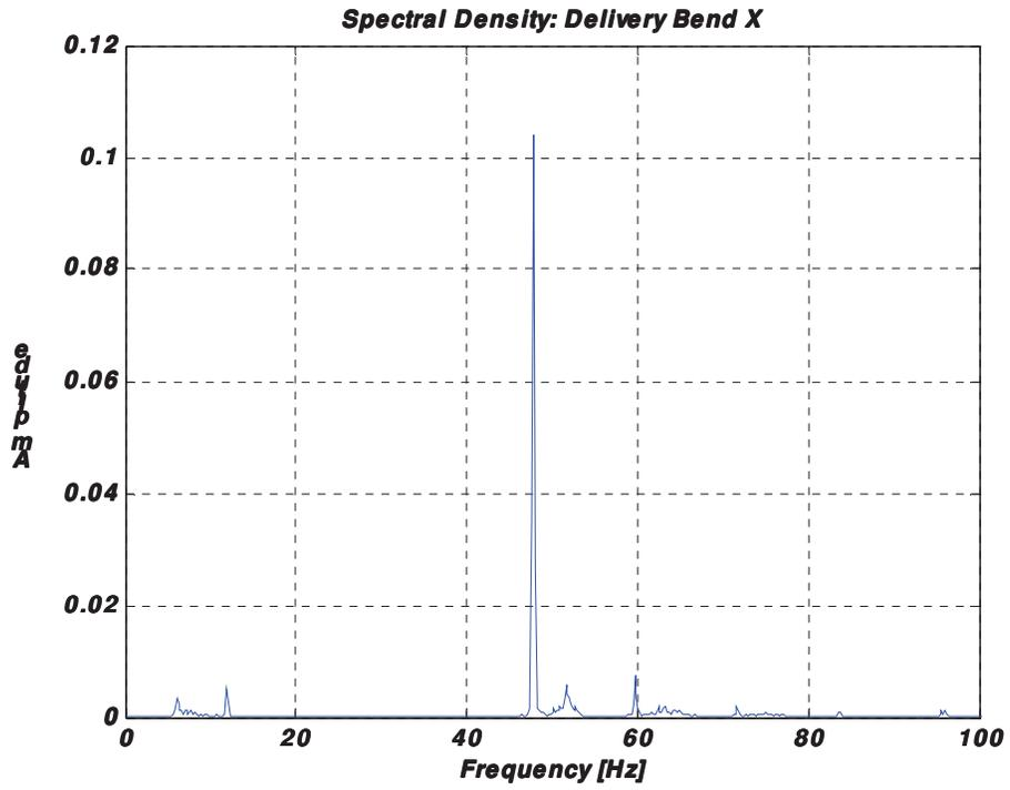
Figura 5.9: Registro no tempo e PSD: bocal de recalque X = 1 mm/s RMS.
