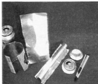
Figura 7.4 Ferramenta desenvolvida para moldar as aletas
