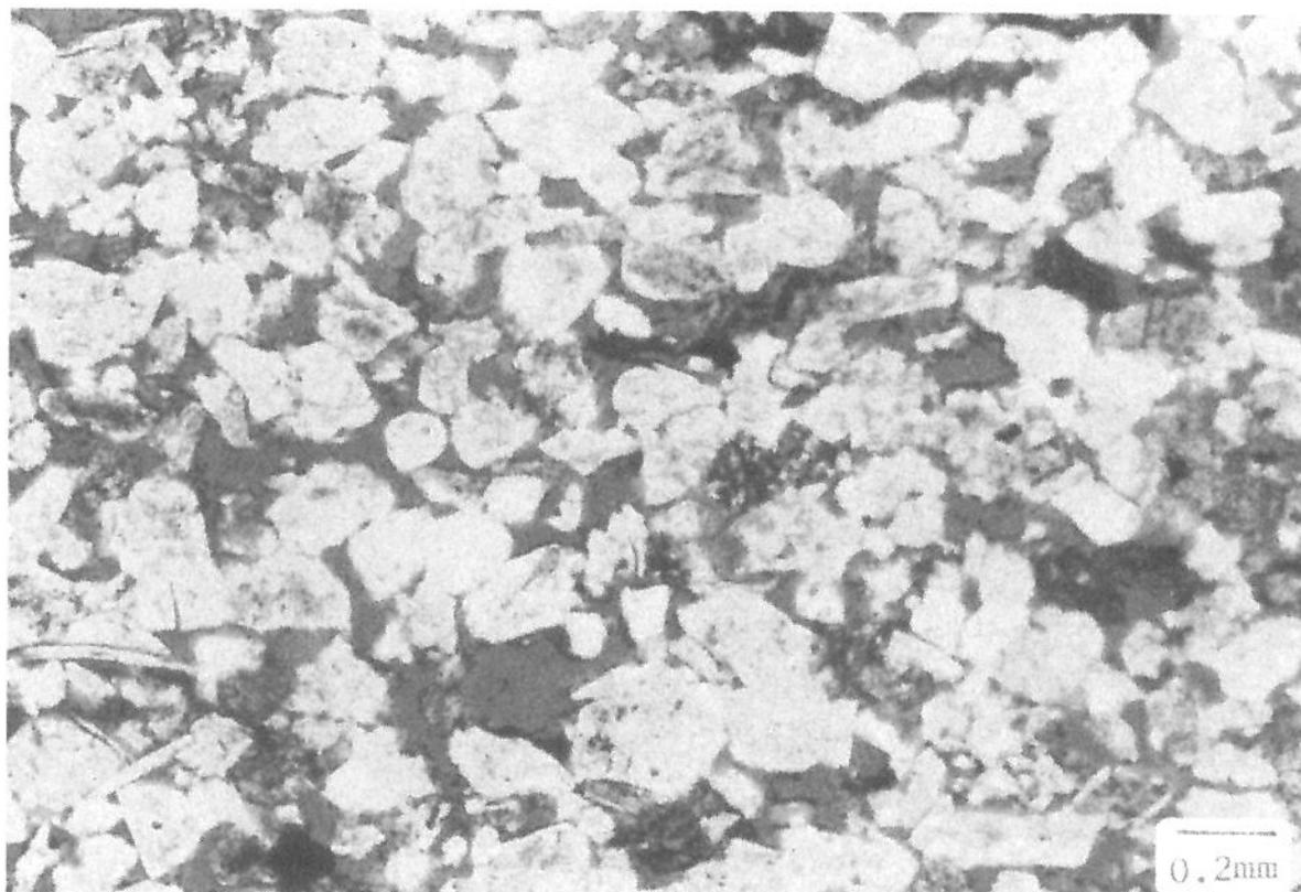
**Fig. II.1.1** - Fotomicrografia de lâmina do arenito Vosges.
