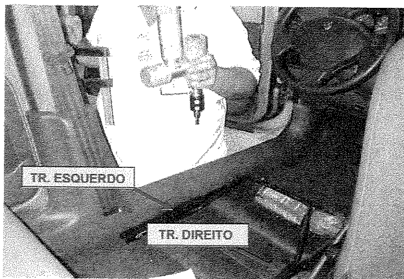
Figura 35- Braço articulado e localização dos trilhos de fixação.
