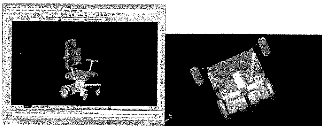
Figura 54 c – Sistemas da base totalmente retraídos.
