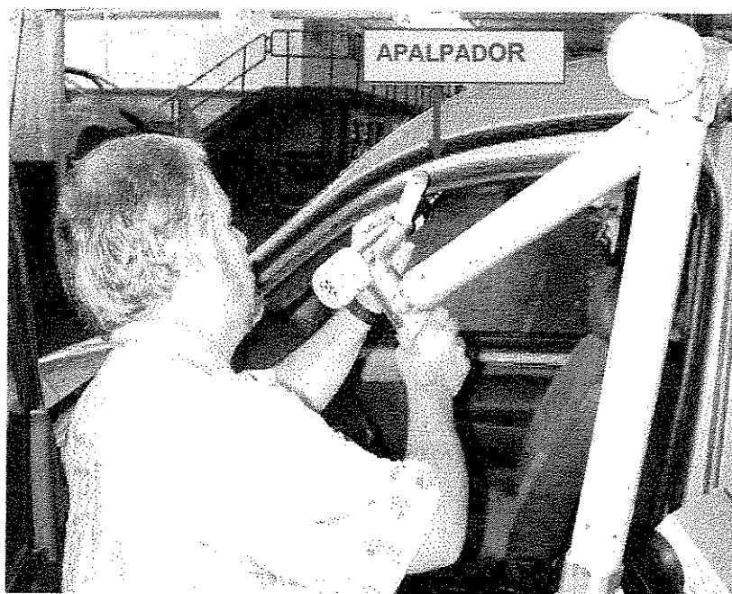
Figura 34- Processo de medição com Braço Articulado Faro.
