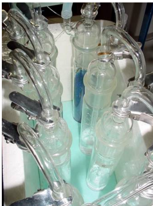
Figura 3-23 Conjunto de borbulhadores posicionados no interior da caixa fria.
