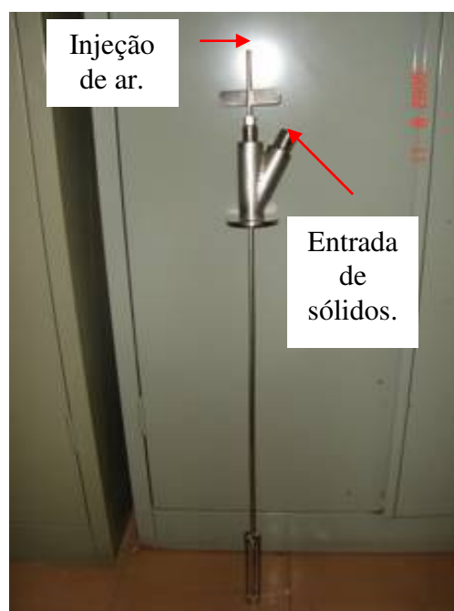
Figura 3-15 Vista do injetor pneumático da mistura combustível.
