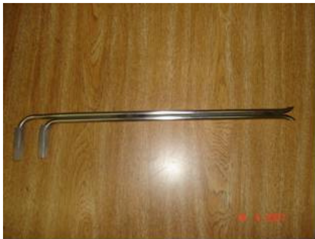
Figura 3-26 Tubo pitot utilizado nas amostragens.
