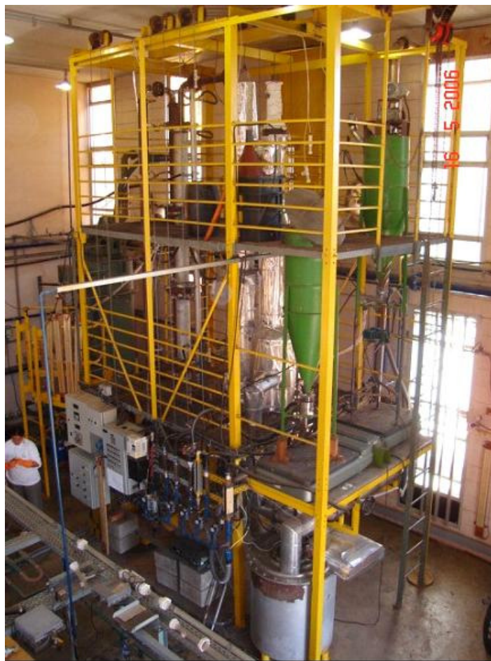
Figura 3-1. Vista geral do combustor com leito fluidizado rápido.
