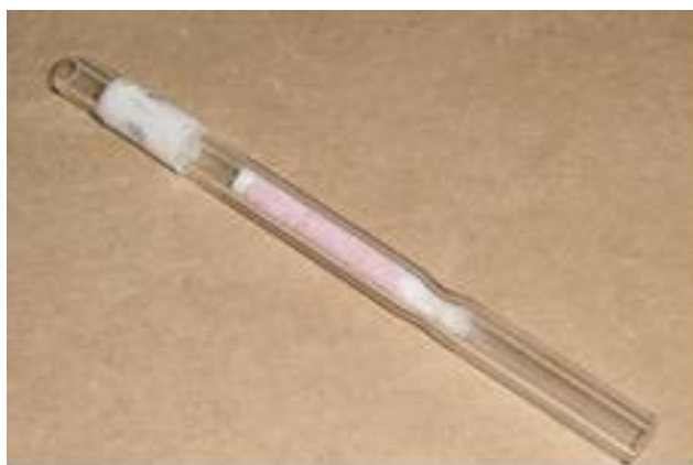
Figura 3-41. Coluna de ouro utilizada para amostragem de Hg.
