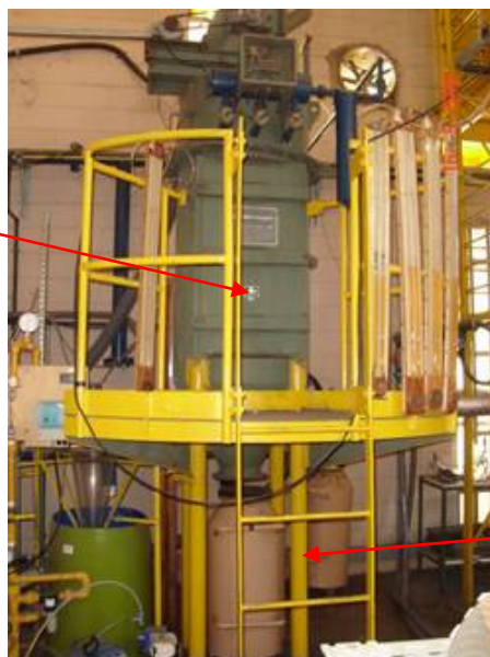
Figura 3-12. Filtro de mangas para coleta das partículas finas do processo.
