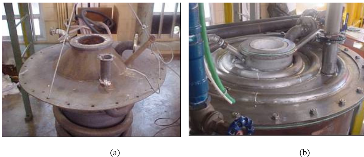
Figura 3-14 Vista da tampa do sistema de pré-aquecimento a GLP.
