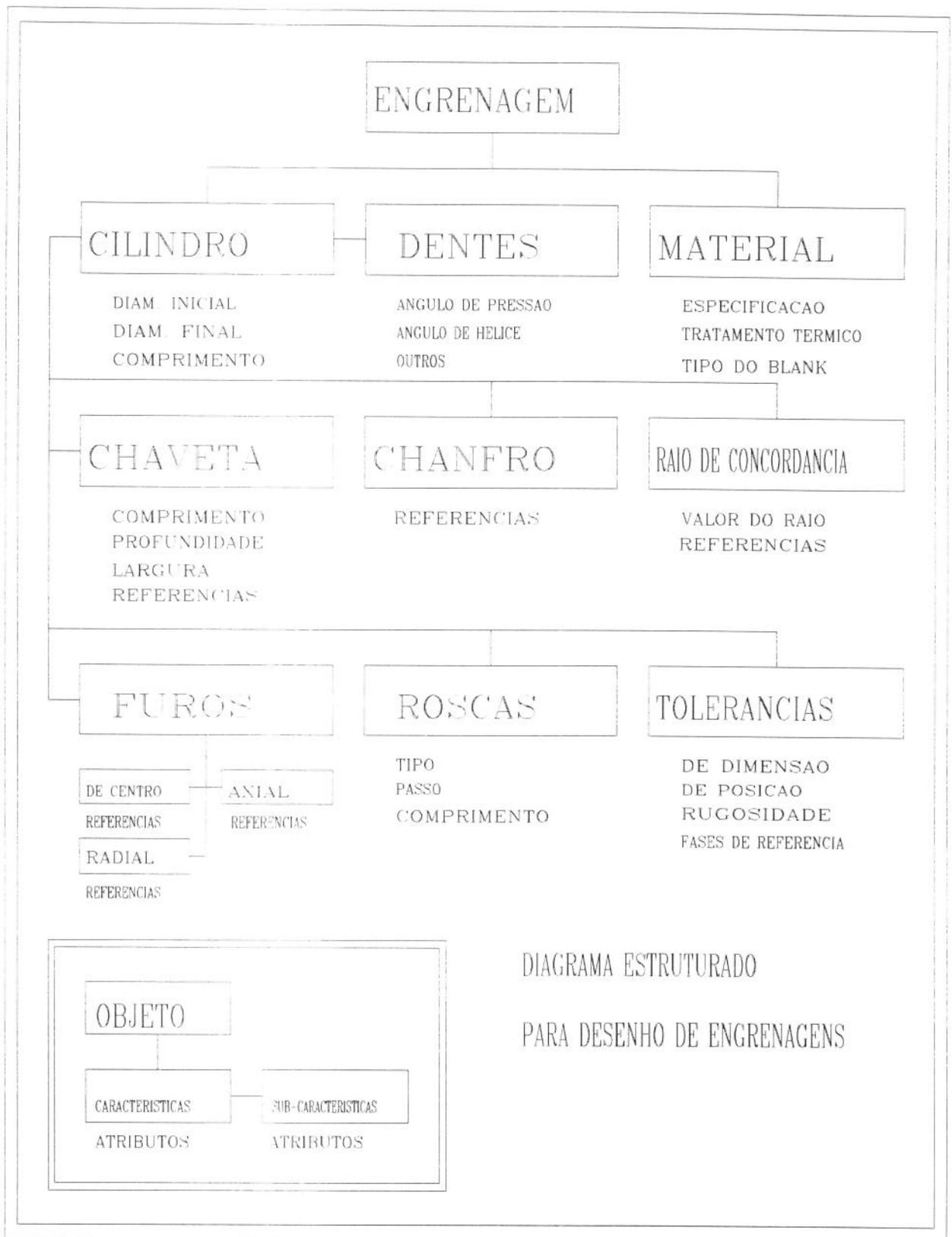
**Figura 3.6. - Diagrama Estruturado para desenho Automático de Engrenagens**
