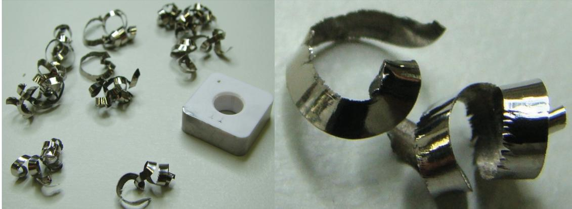
**3) Ferramenta SNGA 12 04 16E – IN11  $v_c$ : 70m/min,  $f$ :0,10mm/volta,  $a_p$ : 0,5mm**
