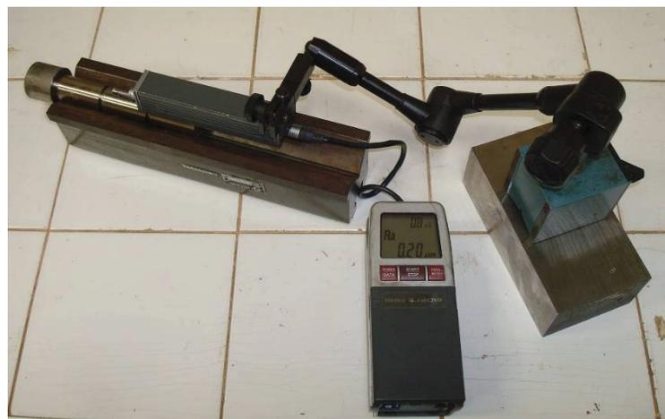
**Figura 3.1.4 – Medição da rugosidade do corpo de prova**
