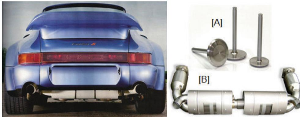
**Figura 2.2.2: Componentes em Inconel, [A] válvulas de admissão e exaustão, [B] sistema de exaustão/escapamento utilizado no Porsche 911. (www.adlerflow.com – 07/2011)**
