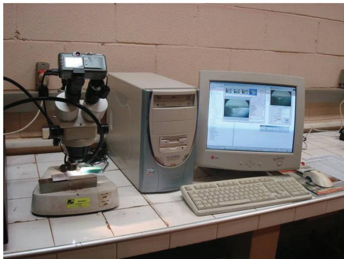
**Figura 3.1.2 - Sistema de captação de imagens e medição dos desgastes**
