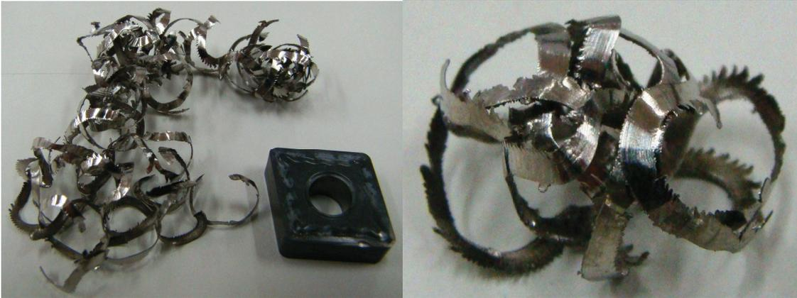
1) Ferramenta CNMG 12 04 12 – QM 1105  $v_c$ : 40m/min,  $f$ :0,10mm/volta,  $a_p$ :0,5mm
