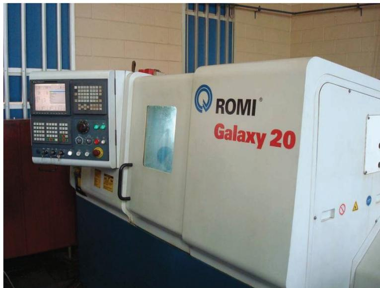
**Figura 3.1 - Torno CNC utilizado nos ensaios**
