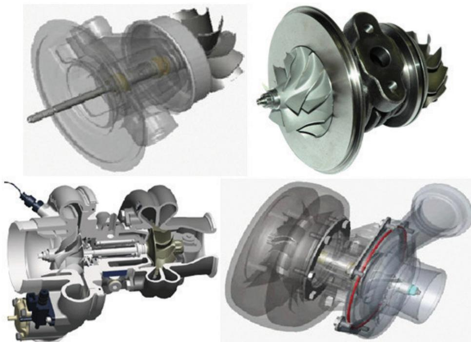
**Figura 2.2.3: Exemplo de aplicação do Inconel 713C em turbos automotivos, detalhe da aplicação do rotor dentro do turbo compressor. (www.biagioturbo.com)**
