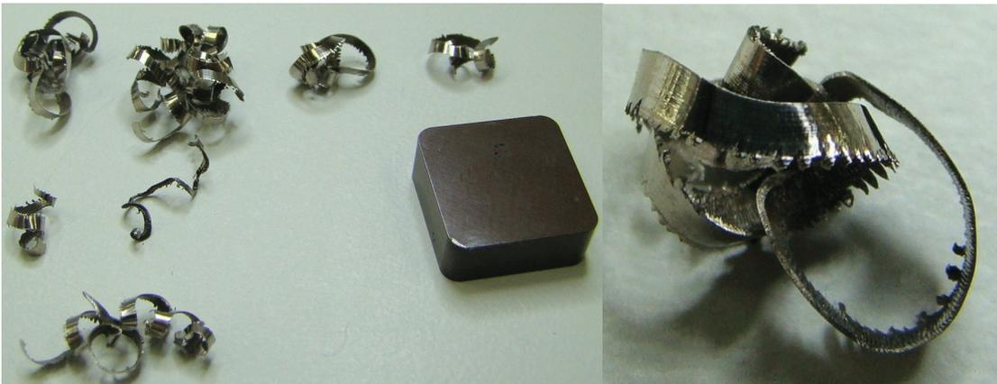
2) Ferramenta SNGN 12 04 16E – IS9  $v_c$ : 70m/min,  $f$ :0,10mm/volta,  $a_p$ : 0,5mm
