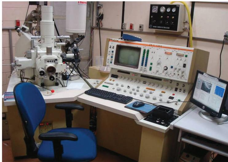
**Figura 3.1.3 – Microscópio Eletrônico de Varredura**
