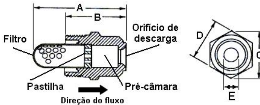
Figura 3.7– Dispositivo atomizador modelo HV-14 (Adaptado de Tyco, 1994)
