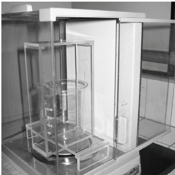
**Figura 3.18.** Dispositivo picnométrico, conforme norma ASTM B 311-93 [Boeira, 2006].
