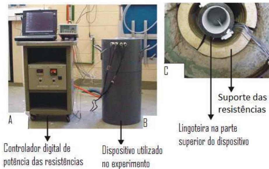
**Figura 3.7.** Dispositivos de solidificação vertical ascendente refrigerado a água: (A) Controlador de potência; (B) Dispositivo de solidificação; (C) Parte interna do dispositivo
