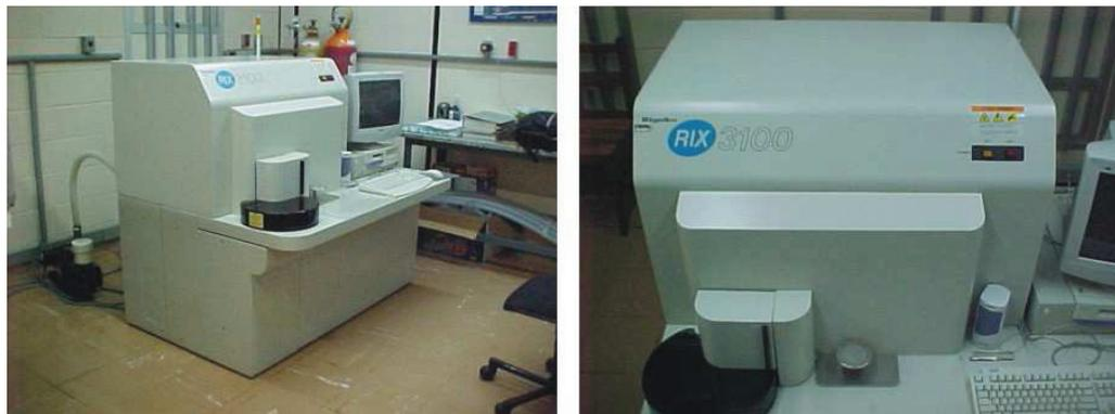
**Figura 3.6.** Espectrômetro de fluorescência de raios X, modelo Rigaku RIX 3100 (Laboratório de Caracterização do Departamento de Engenharia de Materiais da FEM-UNICAMP).
