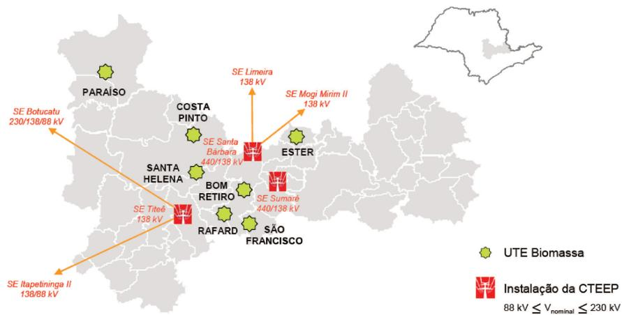
**Figura C. 7** - Usinas de biomassa e demais instalações de transmissão na Área VII (ONS NT-008/2008)
