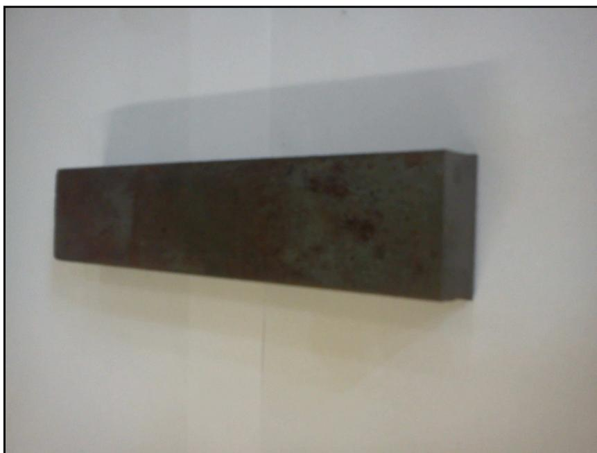
**Figura 3. 2 – Barra de ferro preparada para o ensaio, nas dimensões 250 x 50 x 30mm**
