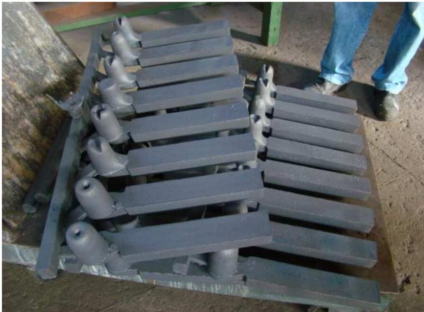
**Figura 3. 1 – Barras fundidas utilizadas no ensaio, logo após a fundição**
