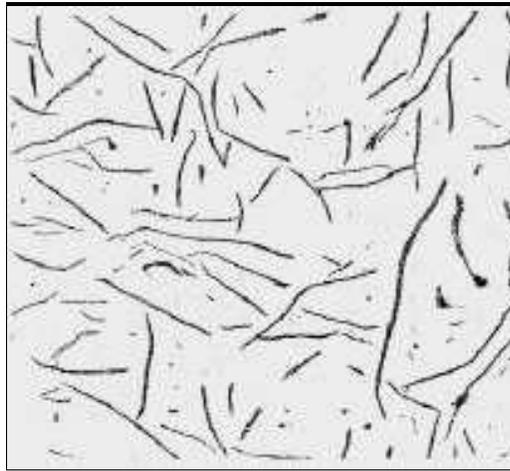
**Figura 2. 10 – Grafita tipo A (100x) (ASM,1985 apud Ferrer, 2006)**
