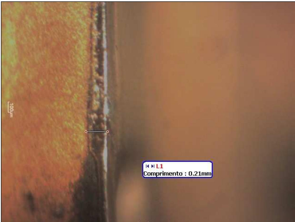
**Figura 4. 4 – Detalhe de desgaste de flanco de inserto de metal duro utilizado na usinagem do material perlítico sob velocidade de corte de 390 m/min e avanço de 0,12mm por dente.**
