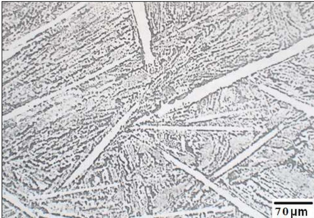
**Figura 2. 4 - Aspecto micrográfico de ferro fundido hipereutético. Ataque: pírico.
