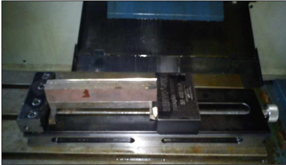
**Figura 3. 7 – Fixação da barra na morsa para usinagem**
