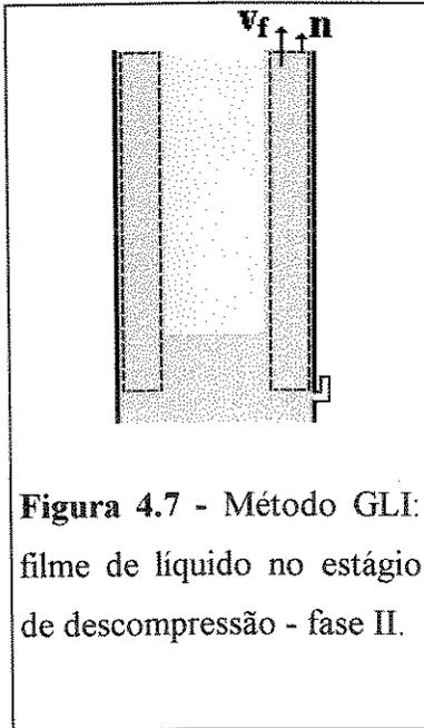
**Figura 4.7 - Método GLI:** filme de líquido no estágio de decompressão - fase II.
