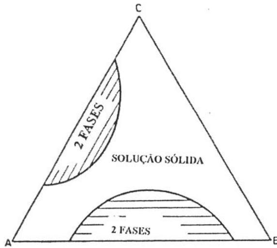
Figura 2.10 - Sistemas com dois gaps de miscibilidade simples compostos de dois metais cada um [1].
