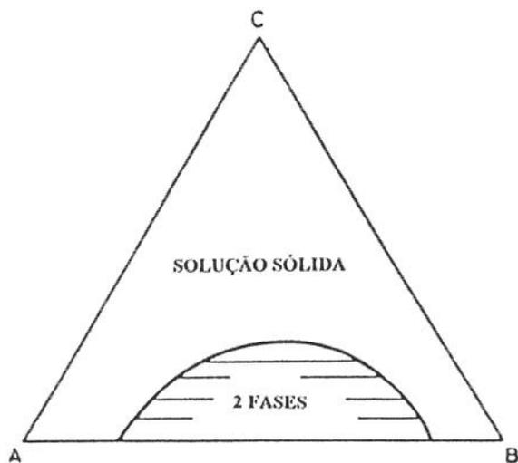
Figura 2.9 - Gaps de miscibilidade simples composto de dois metais delimitando uma região dentro do sistema ternário [1].
