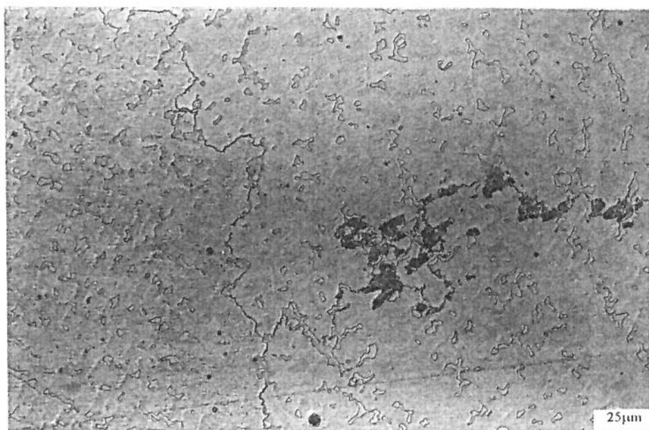
**Figura 4.2** - Distribuição dos Carbonetos dentro e no contorno do grão dendrítico
