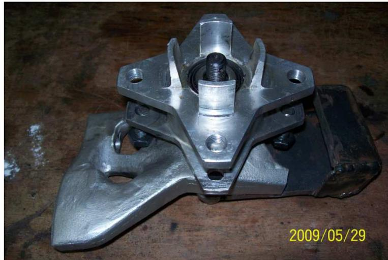
Figura 4.2: Componente Manga de Eixo quebrado
