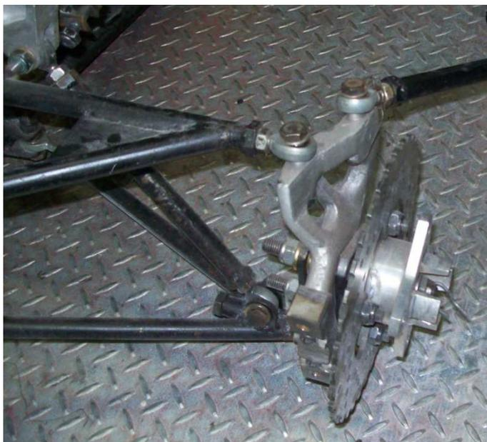
Figura 4.3: Sistema de suspensão dianteiro Formula SAE
