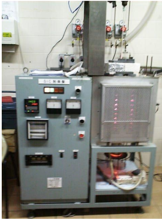
Figura 2-7. Forno Ikoma utilizado no LIQC para o processo de desidratação e consolidação.
