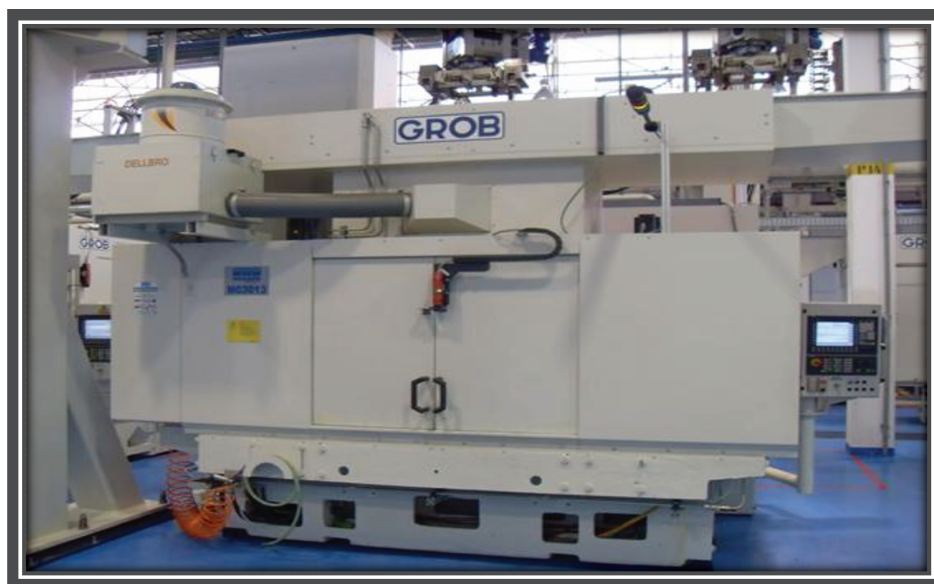
Figura 2.12 – Centro de Usinagem Horizontal – CNC GROB
