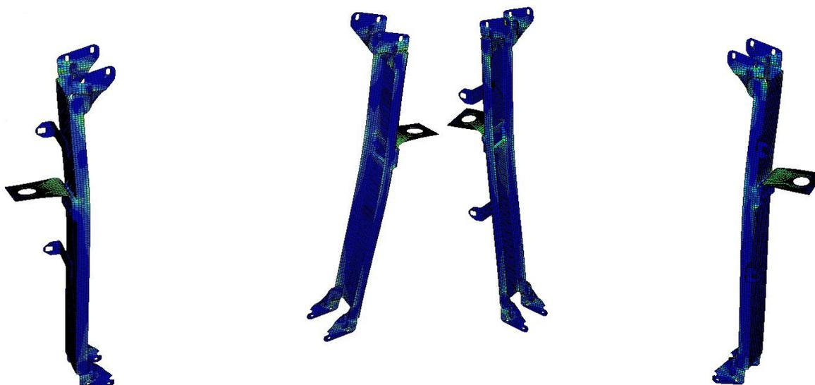
Figura 34 – Simulação com acelerações negativas, vistas isométrica frontal e traseira
