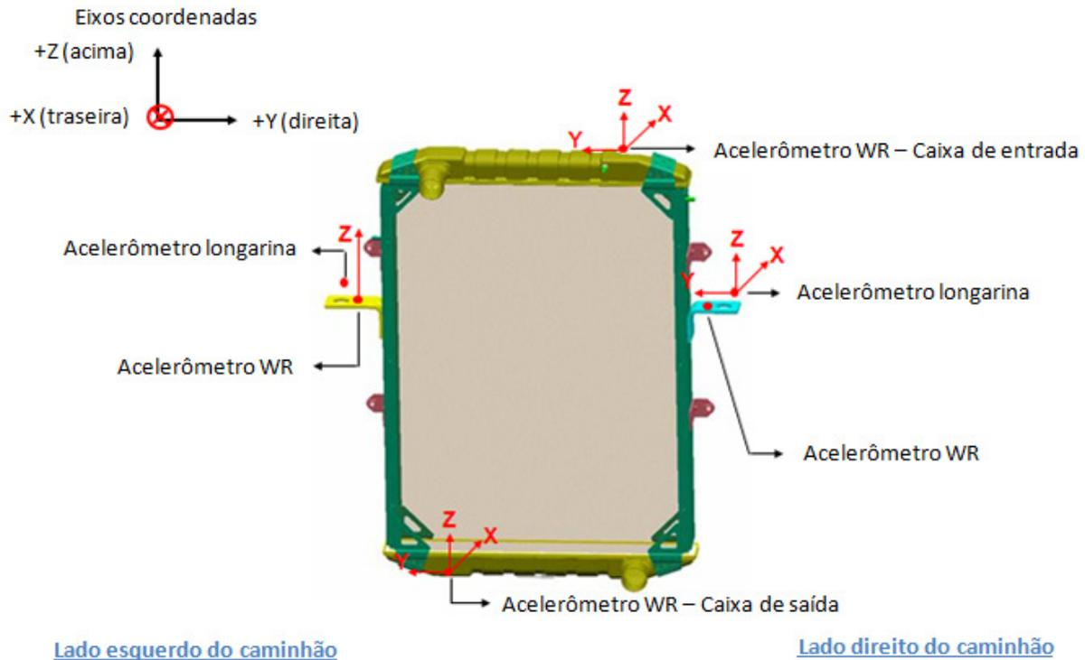
Figura 18 – Posicionamento dos acelerômetros
