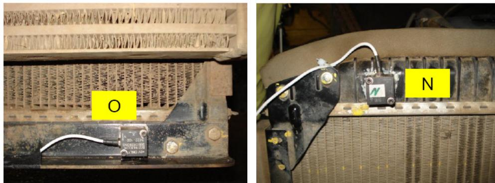
Figura 21 – Acelerômetros “O” preso ao suporte do tirante e “N” preso à caixa superior, respectivamente
