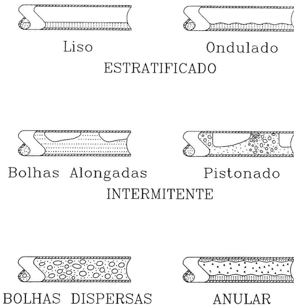
Figura 1.1: Padrões no escoamento bifásico horizontal.
