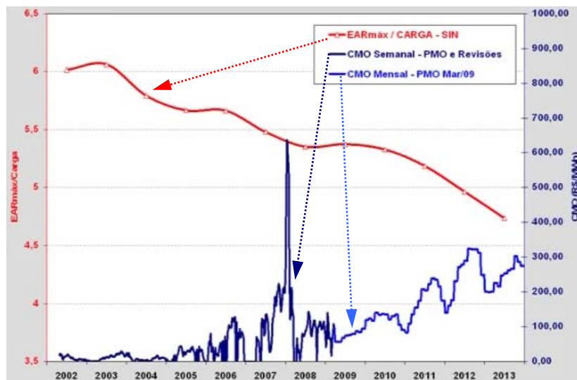
Figura 4.23 - Comportamento da relação EARMáx/Carga em relação ao CMO
