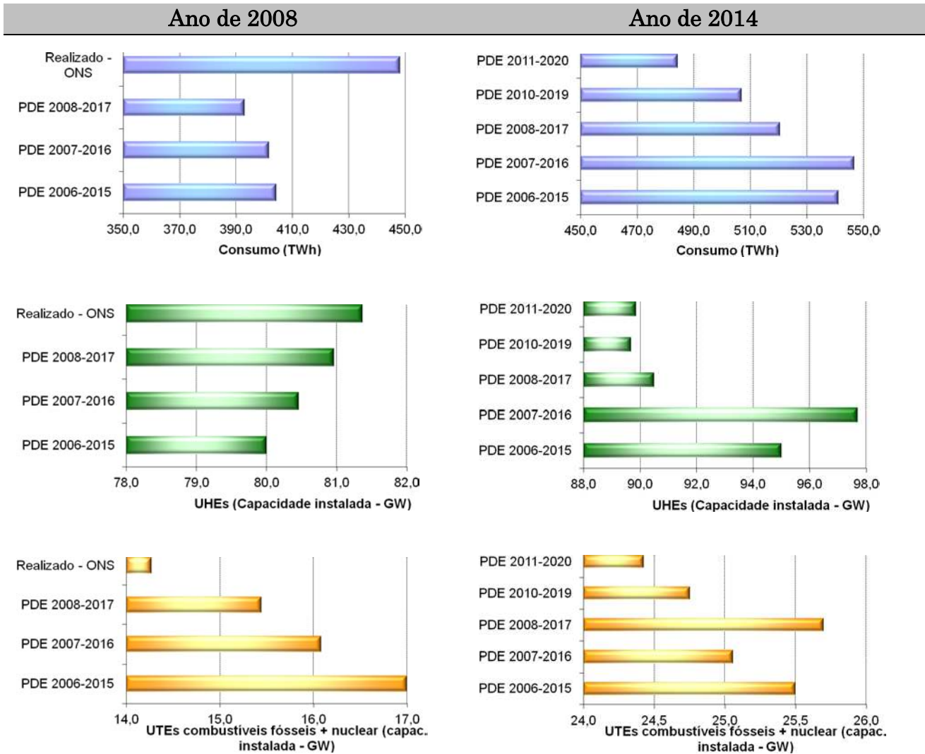
Figura 3.4 - Previsões de consumo de eletricidade e capacidade instalada em usinas hidrelétricas e centrais termelétricas dos PDEs para os anos de 2008 e 2014 e valores verificados em 2008
