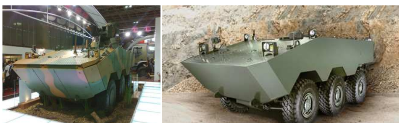
Figura 1.6 –VBTP-MR: um blindado 6x6 de transporte de pessoal desenvolvido em conjunto pela Fiat-IVECO e Exército Brasileiro (VBTP-MR Project, 2011).
