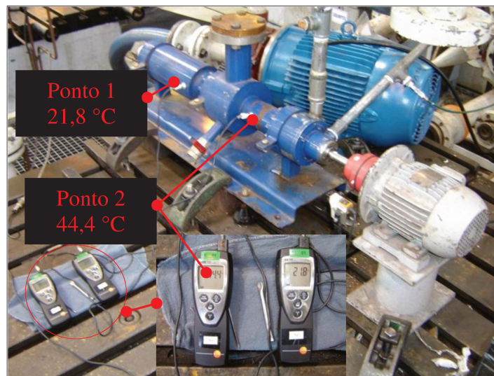
Figura 4.12 – Localização dos pontos para as medidas de temperatura, modo bomba, carcaça A. Ponto 1, entrada da bomba centrífuga. Ponto 2, região próxima ao mancal da BFT.
