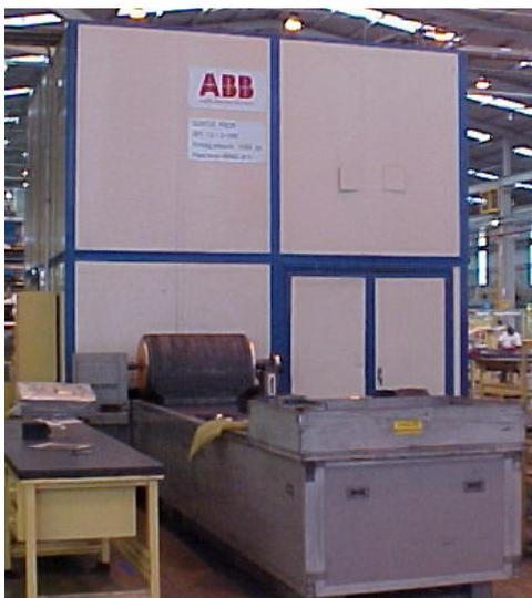
Figura 3.8 – Prensa com célula hidráulica empregada para a execução dos ensaios.
