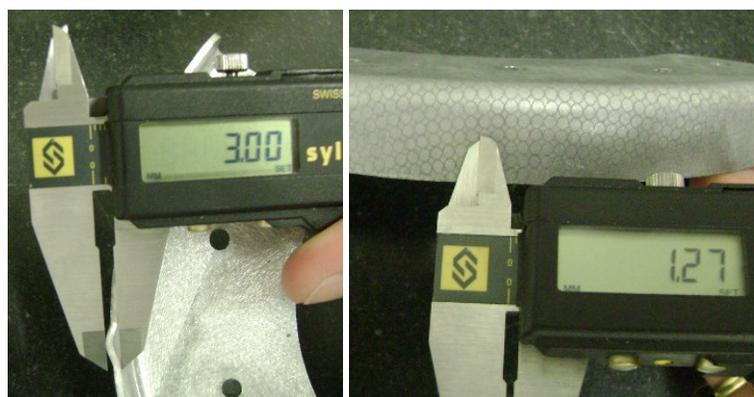
Figura 3.17 – Procedimento para verificação da altura da ruga e deformação dos círculos.
