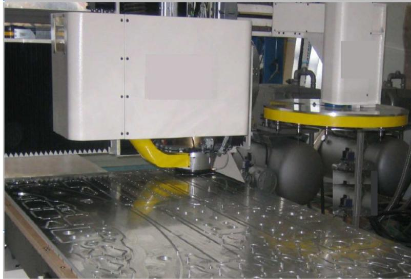
Figura 3.3 – Centro de usinagem três eixos utilizado para o fresamento dos *blanks*.
