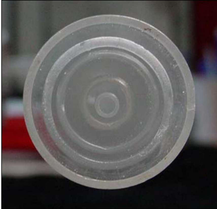
Figura 3.1-1. Maçarico de 5 vias utilizado no VAD.
