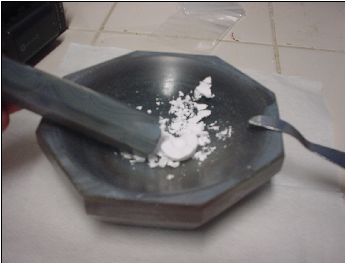
Figura 4.2-2. Nanopartículas de \text{TiO}_2 sendo triturada para posterior caracterização.
