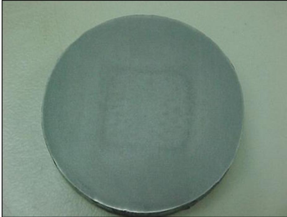
Figura 4.1 – Macrografia da amostra laminada bruta L(0) (sem aumento)
