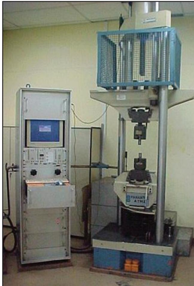
Figura 3.5 – Máquina para ensaio de tração
