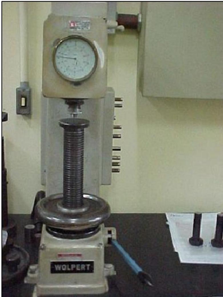
Figura 3.4 – Durômetro para medições de dureza
