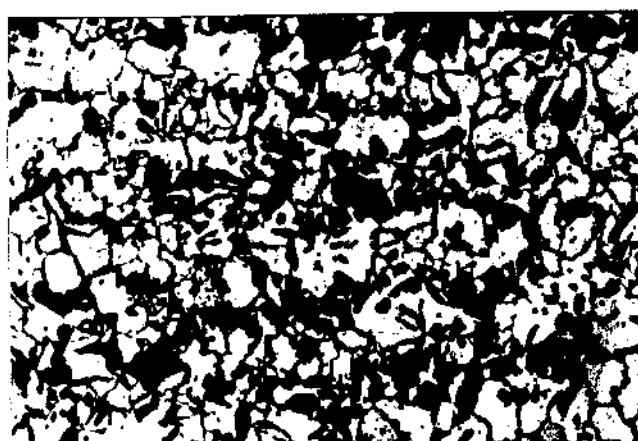
LONGITUDINAL FORA DO CENTRO 400X. NITAL 3,5 %
