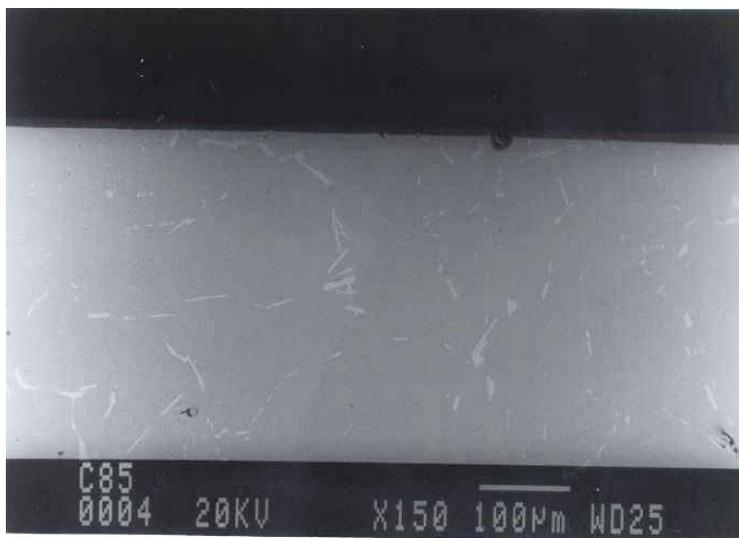
Figura 4.11: Micrografia (MEV) da liga Al-Cu tratada termicamente
