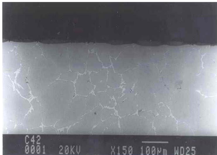
Figura 4.10: Micrografia (MEV) da liga Al-Cu sem tratamento térmico
