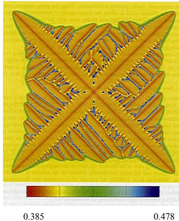
Figura 3.3. Simulação de uma liga Ni-Cu em crescimento dendrítico num líquido super-resfriado pelo modelo de campo de fase. A escala mostra a variação da concentração, em fração atômica de Cu, no líquido e no sólido para parâmetros que aproximam a liga Ni-Cu com fração 0.41 de Cu [Warren, 1995].
