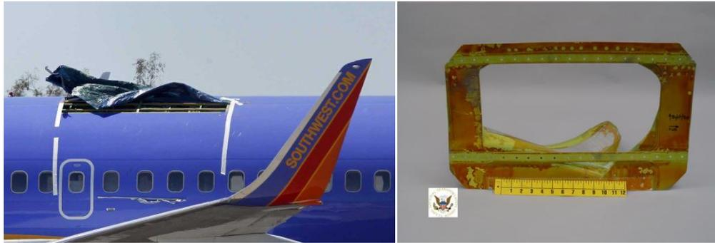
**Figura 1.5: Dano em fuselagem do Boeing 737 da Southwest Airlines.**
