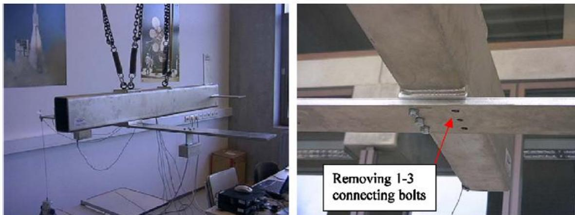
**Figura 2.11: Bancada experimental do trabalho de Yan e Golinval**
