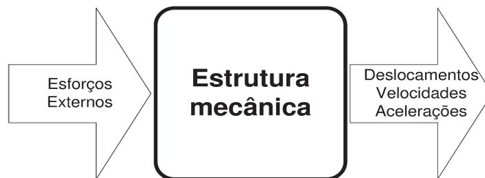
**Figura 3.1: Representação em bloco de uma estrutura mecânica**
