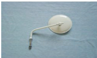
Figura 9: Retrovisor esquerdo VW Kombi ano 1971. Fonte: catálogo VW Kombi 1971.
