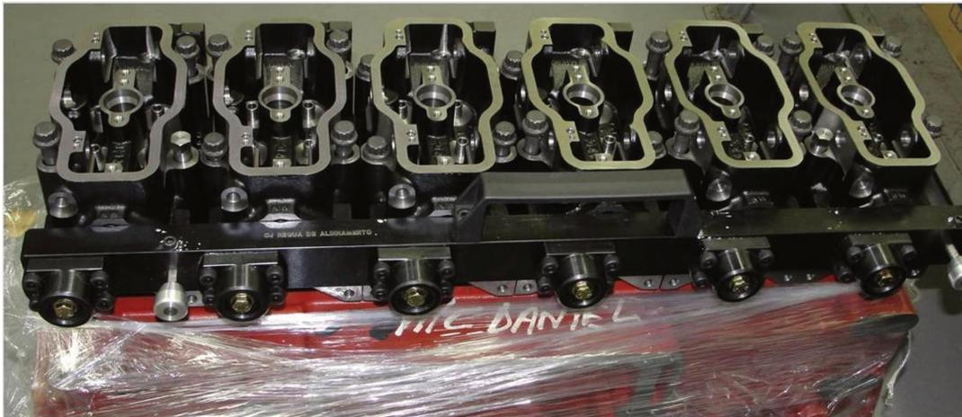
**Figura 19. Montagem do Cabeçote com auxílio da Régua.**
