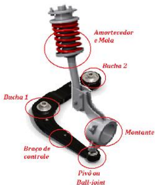
Figura 16 – Suspensão dianteira do tipo McPherson, localização de componentes.
