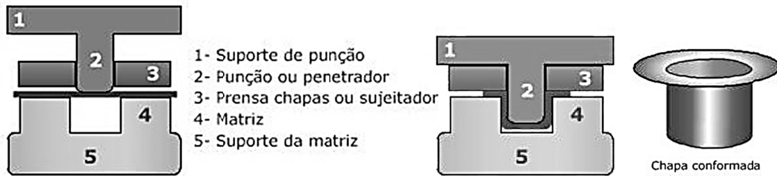
Figura 2.1 - Esquema do processo de estampagem profunda (CIMM, 2011)
