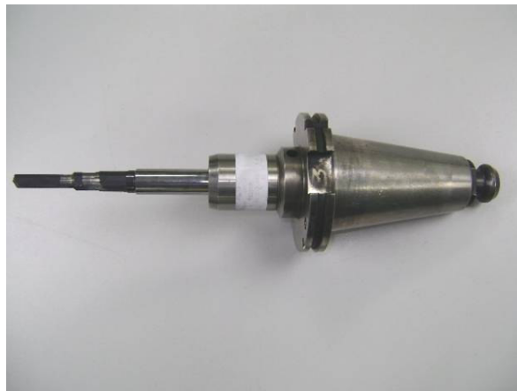
Figura 3.4 - Conjunto ferramenta/mandril hidráulico com cone de fixação ISO 50.
