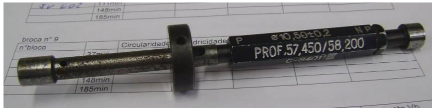
Figura 3.8- Calibre padrão passa não passa do diâmetro e profundidade do furo.
