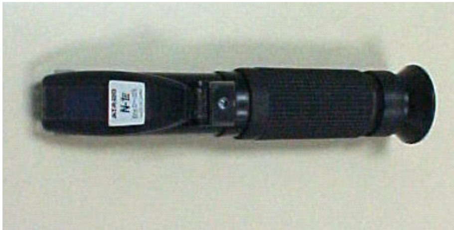
Figura 3.6 - Refratômetro utilizado para manutenção da concentração do fluido ATAGO N-1E.
