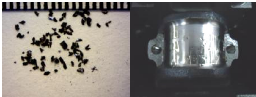
Figura 28: a) Partículas de ferro fundido de tamanho médio 1 mm e peso 23 mg; b) partículas sobre o moente do virabrequim simulando impurezas oriundas do fechamento da biela.
