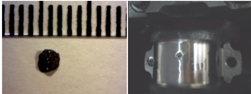
Figura 27: a) Partícula de aço de aproximadamente 2mm; b) partícula sobre o moente do virabrequim simulando uma impureza oriunda do fechamento da biela.
