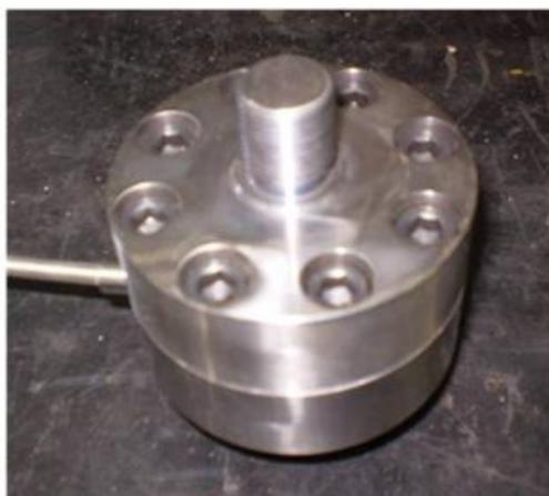
Figura 4.9: Célula de carga utilizada para a obtenção de  $L^2_{11}$  e  $L^3_{11}$ .
