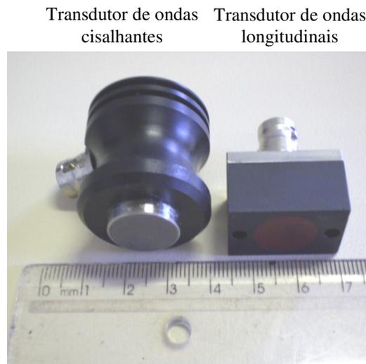
Figura 4.2: Transdutores de ondas longitudinais e cisalhantes utilizados para medição das constantes elásticas de segunda ordem.
