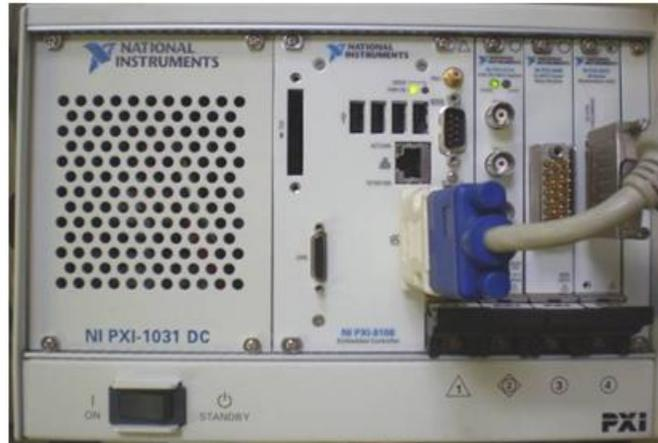
Figura 4.15: Módulo contendo o controlador embarcado PXI 8108 e as placas digitalizadoras.
