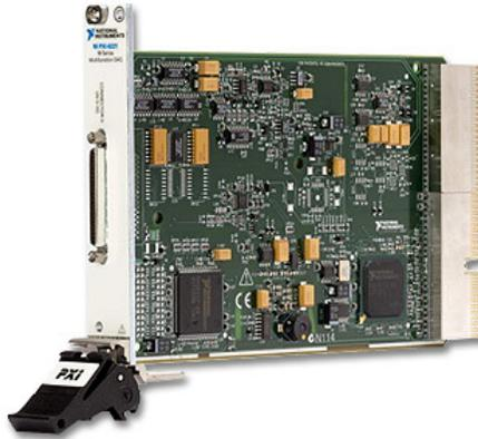
Figura 4.11: Placa de aquisição NI PXI-6221 (NATIONAL INSTRUMENTS).
