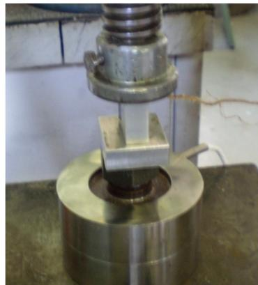
Figura 4.40: Amostra posicionada na prensa para medir  $L^2_{11}$ .
