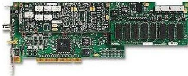
Figura 4.14: Placa digitalizadora NI 5911 (NATIONAL INSTRUMENTS).
