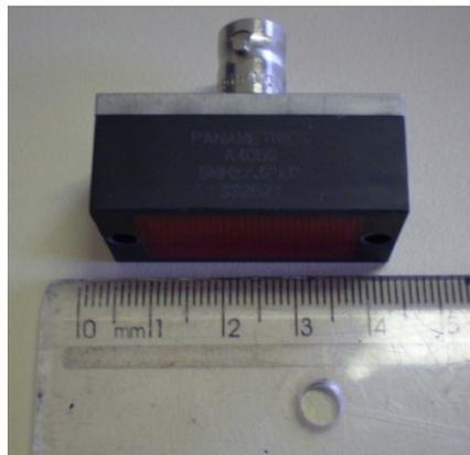
Figura 4.5: Transdutor de ondas longitudinais utilizado para geração de ondas  $L_{cr}$ .
