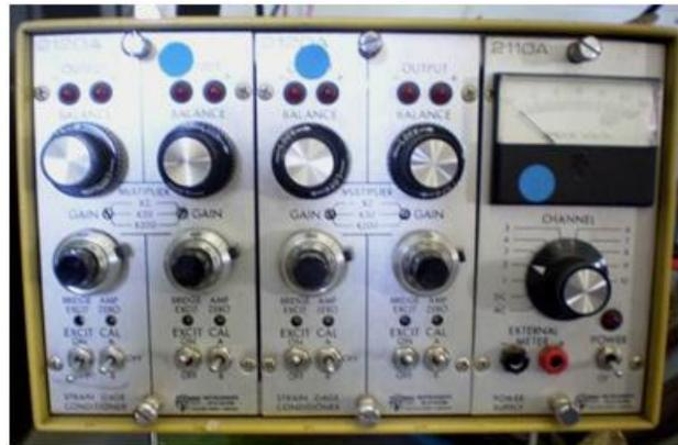
Figura 4.13: Amplificador/Condicionador para sinais de sensores de torque.
